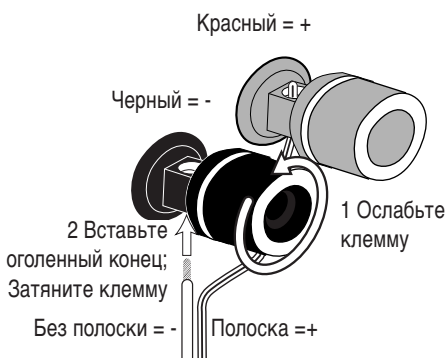
Рисунок 4. На этом рисунке показано, как следует подсоединять оголенные концы кабелей к клеммам.
